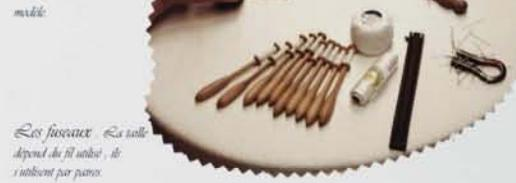
Les fuseaux. La taille dépend du fil utilisé, ils s'utilisent par paires.
